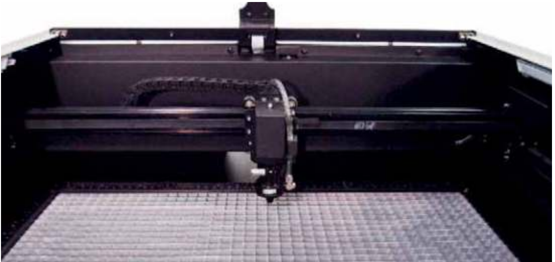
Der Servomotor beschleunigt die Gravureinheit auf Arbeitsgeschwindigkeiten von bis zu 50,8 cm pro Sekunde.
